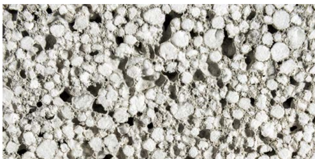
Deutlich sichtbar: gebundene EPS-Partikel in verschiedenen Sieblinien und ausreichend Luftporen.
