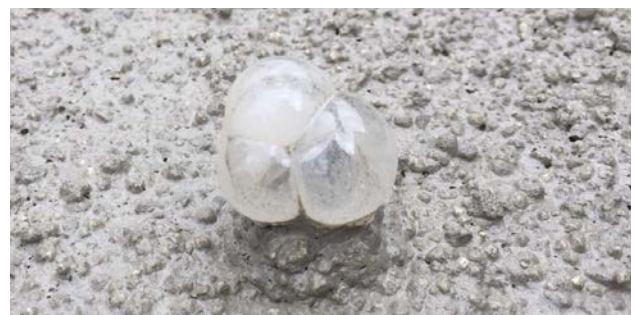
Luftporenbildung als Ergebnis des einzigartigen 4-Komponenten Bindemittels sorgt für die guten Dämmeigenschaften im Gesamtaufbau.
